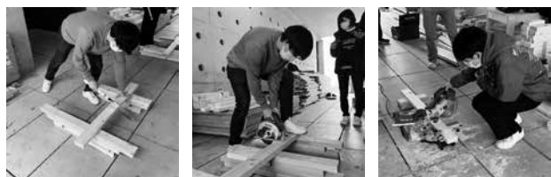
手ノコ ハンディ丸ノコ スライド丸ノコ 図5 木材のカットの時間計測試験の様子
