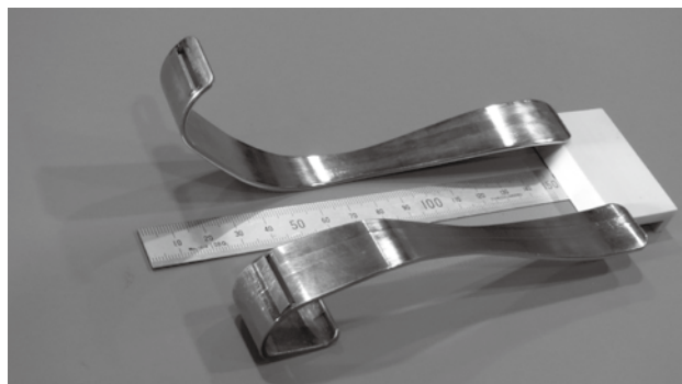
図2 切削加工したバターナイフ
