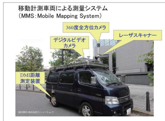
図8 移動計測車両による測量システム(MMS)
