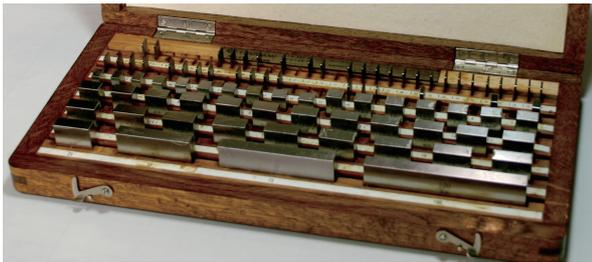
図5 金属製のブロックゲージ (103個組)
