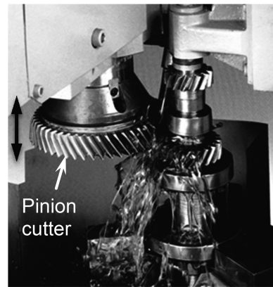
図10 歯車形削り盤による歯車の創成加工
