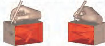
図1、図2はモデリングデータのイメージである。下の筐体の中にある「手」は面が逆転し、空洞になっている。透明のアクリル樹脂で造形した場合「手」の形が透過して見ることができる。
