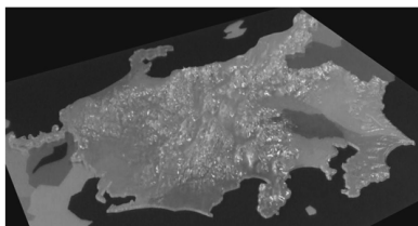
図は3D-CADで作成した立体地図のCG画像である。 スケールの小さなモデルでは高さ区分が十分に強調できなかった。 印刷された従来の地図では分かった地形の特徴を読み取ることができる。
