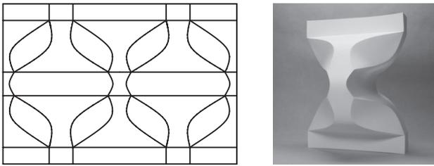
図11 柱面の直線エレメントに垂直でない鏡映面での折り返しを使用した形の例。
