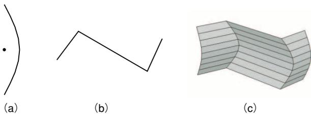
図8 (a) 側面線。中央の点は掃引軌跡の端点の位置。(b) 掃引軌跡。(c) 与えられた側面線と掃引軌跡から生成される立体。1枚の紙を折って作ることができる。
