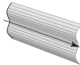
図5 側面線(太線で示した曲線)を矢印で示す軌跡で掃引すると、柱面が得られる。
