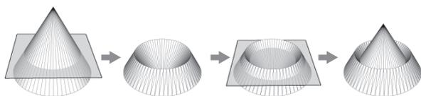
図3 円錐の頂点を含む側を平面で反転させる操作。得られる形は最初の円錐と同じ展開図から作れる。
