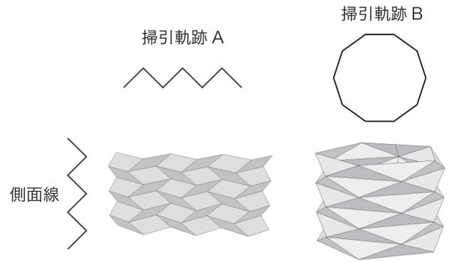
図9 ミウラ折り(左)と吉村パターン(右)の生成例。どちらも同じ側面線から、掃引軌跡を変えることで生成される。
