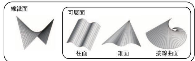
図1 曲面の分類。可展面は線織面の一種。
