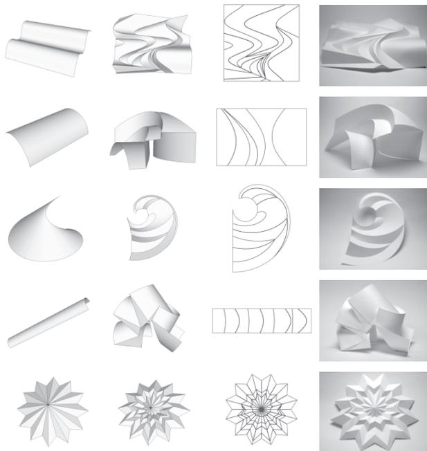
図12 文献 [6] で示された方法で設計された形。左から順に初期形状、編集後の形状、展開図、立体折り紙の写真
