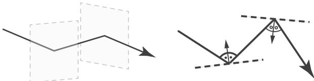
図7 鏡映面によって掃引軌跡の進路が反転する(左)。逆に掃引軌跡から鏡映面の位置を定める(右)。
