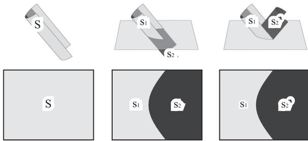
図2 (左)元の可展面  $S$  とその展開図。(中央)  $S$  を横切る平面によって2つの領域  $s_1$  と  $s_2$  に分割する。(右)  $s_2$  を平面で鏡映変換させて  $s_2'$  とする。展開図に変化は無い。
