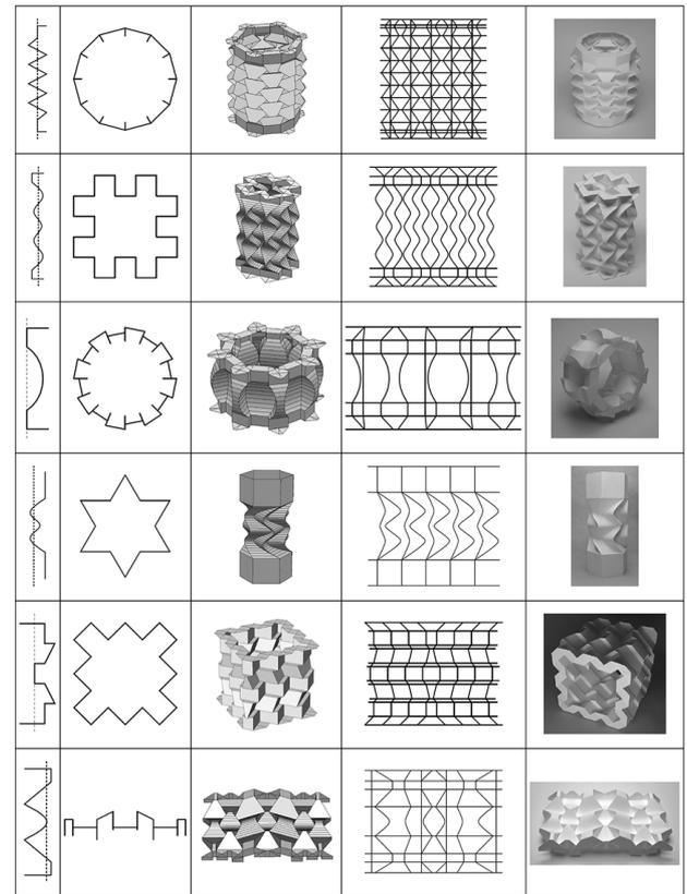
図10 柱面を折り返すことで作られる形の例。図の左から順に、側面線、掃引軌跡、3 DCG モデル、展開図の一部、実際に作った折り紙の写真。
