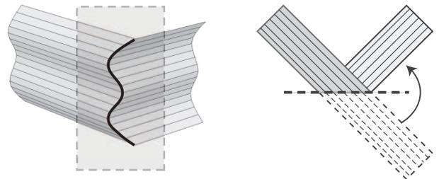
図6 柱面を横切る平面で一方を鏡映変換すると、新しい折りを追加できる。
