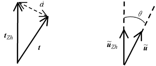
図2 基準カメラによる位置の不定性の除去 左：位置の誤差評価，右：姿勢の誤差評価
