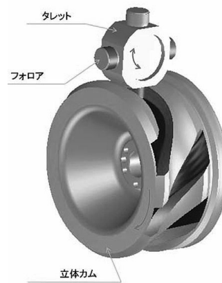
最優秀賞 立体カムとローラフォロアの相対運動による包絡面
