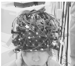
図4 (3×7)ファイバホルダ装着時の様子
